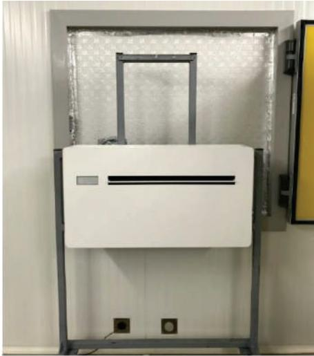
I test sono stati eseguiti in una doppia camera climatica calibrata secondo le normative EN 14511-2 e EN14511-3
